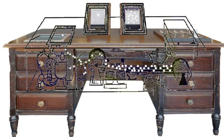
Das Vater Tochter Team von Trevor Smith und Sparks Webb versorgten sich mit allen zur Verfügung stehenden Material an Spezifikationen der Gedächtnis-Erweiterungsmaschine des Herrn Bush aus dem Jahr 1945. 2014 ist es soweit. Die Memex 001, die fleischgewordene Idee des ersten Informatikers arbeitet. Eine interne Kamera erfasst Dokumente und auf den beiden Bildschirmen werden Hypertext-Spuren angezeigt. 2014, im digitalen Zeitalter kein Problem. 1945 nur Fantasie.
